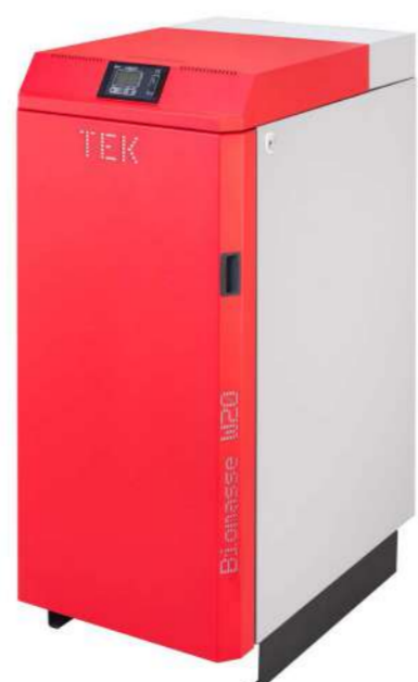
BIOMASSE W LENHA | 104 - 34.7 KW DIMENSÕES 610x1328x950 CM RENDIMENTO 90% DEPÓSITO 35 KG
