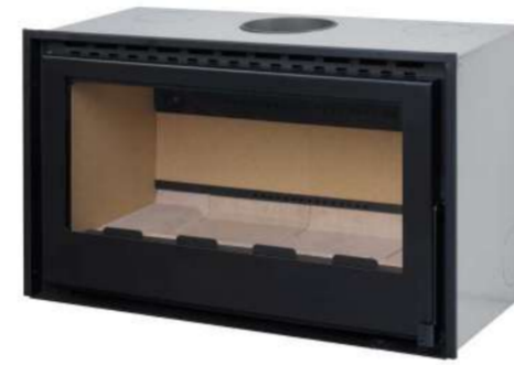
ARTEK 90 LENHA | 14 KW DIMENSÕES 899x596x445 CM RENDIMENTO 82% ÁREA DE AQUECIMENTO 200 M2
